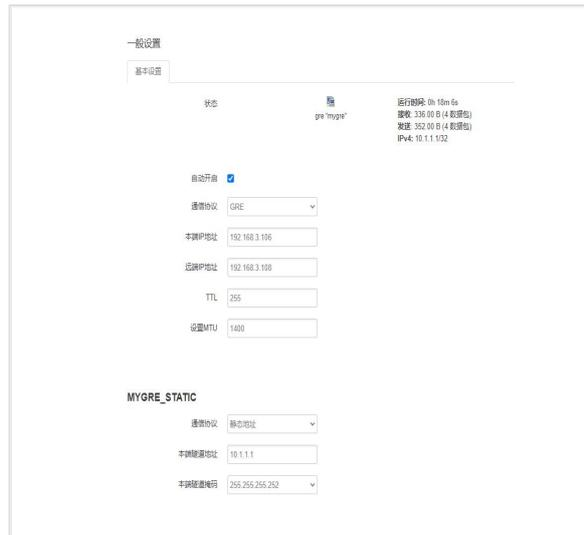
在网关 1 上，通过网络诊断指令能够 ping 通网关 2 的本端隧道地址。然后可验证网关 1 下所挂的设备去 ping 网关 2 下所挂的设备的 ip，能 ping 通即搭建成功。
