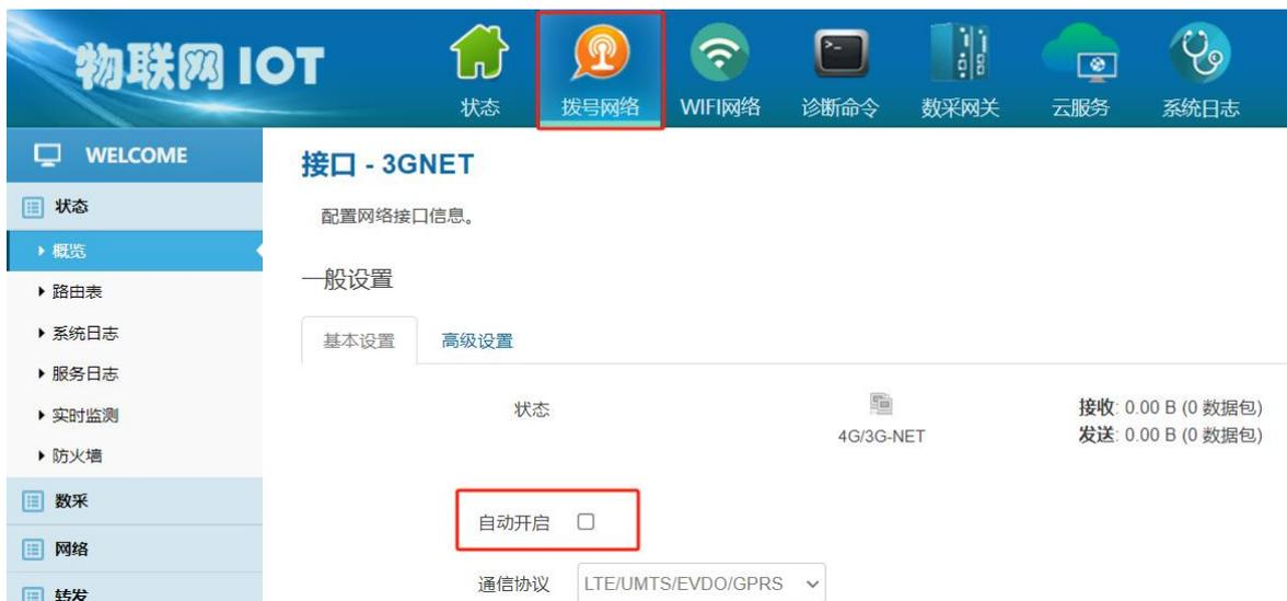
进入“WAN 外网”，自动开启打勾，如下图，如果显示获取到上一级路由分配的 IP 地址就表示已经通过 WAN 口上网。最好通过诊断命令中的 ping 下百度再次确认下。
