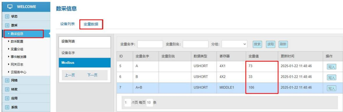
跨设备运算：支持一台网关底下多台设备里变量间的公式计算，在**设备序号**前添加\$符号并且在设备底下变量名前添加@符号表示某台设备底下的某个变量，例如\$01@A+\$02@B表示中间变量的运算是设备序号为01的设备底下变量A与设备序号为02的设备底下变量B的和。
