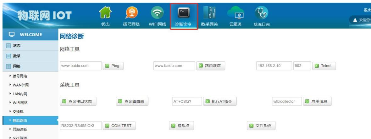
Ping 命令：可用于设备 4G 网络、有线以太网网络、WiFi 网络的网络情况，也可用于判断网关与网口设备的连接情况
