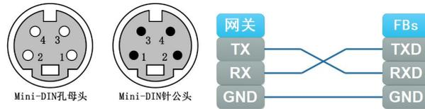
② 电脑通过编程线连接永宏 PLC，使用编程软件“WinProLadder”连接并上载 PLC 设置，点击“PLC”→“设定”，选择对应的 Port（PLC 面板上有说明，Port0 为编程口，Port2 为扩展通讯板）进行串口参数配置。
