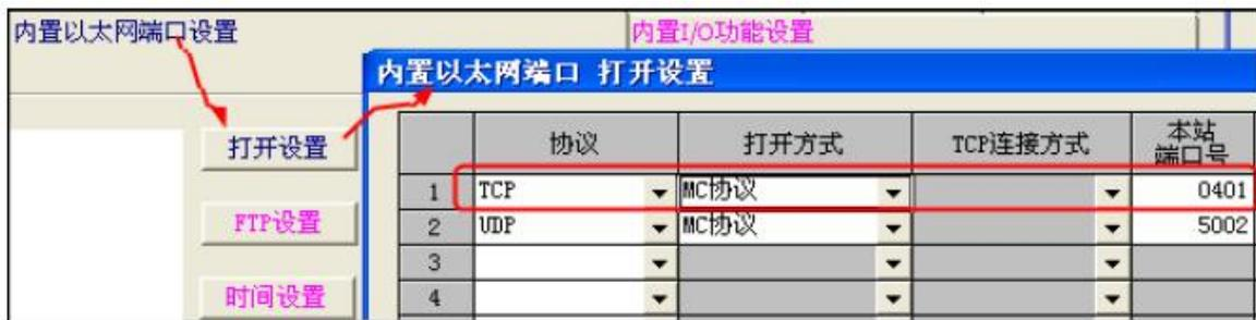
外置以太网模块，选择“TCP”协议，“Unpassive”打开方式，如下图：
