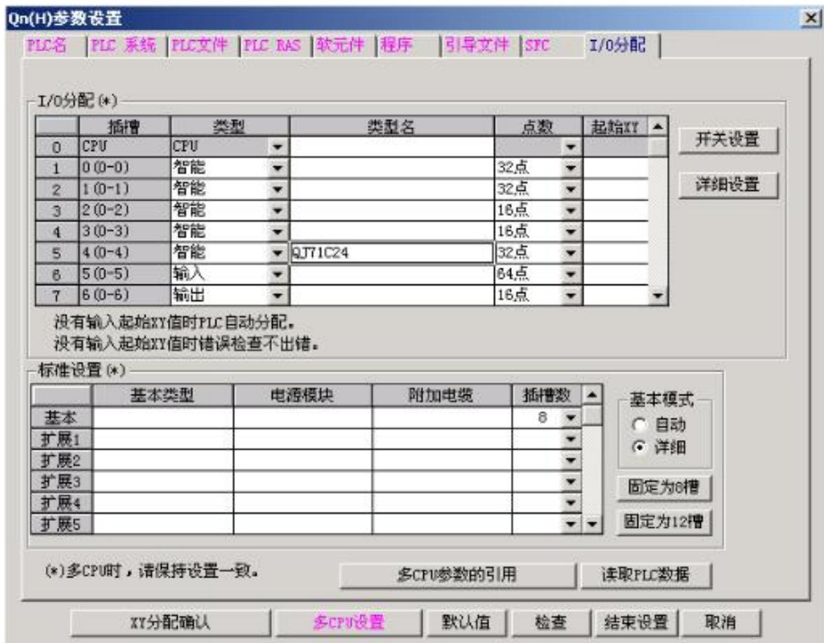
② 在“IO 分配”里面选中串口模块,单击“开关设置”按钮,在弹出的对话框中配置串口参数如下:
