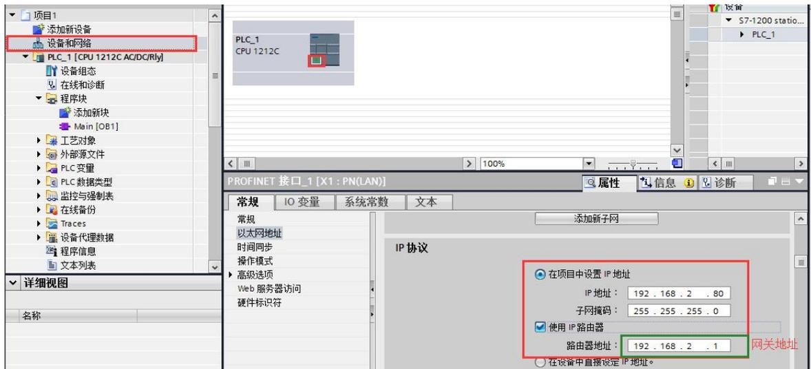
注：PLC 程序需检查是否开启 PUT/GET 允许远程访问功能！（如未开启，网关日志将打印
