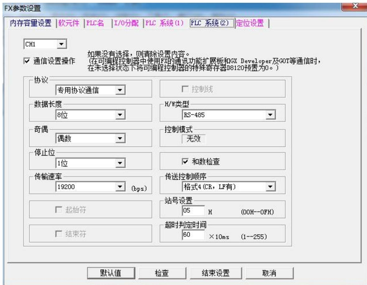
固定值：协议：“专用协议通信”；H/W 类型：“RS-485” 传送顺序控制：“格式 4”。
