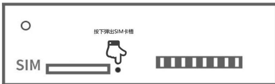
使用细长物品，对准 SIM 卡槽右边按钮按下，可弹出 SIM 卡槽，将 SIM 卡（大卡）放在卡槽上，装回网关即可
