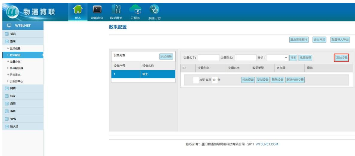
填写点位相关信息，变量名（任意），变量别名（任意），变量类型（根据点位数据类型选择，具体可查看网关支持的数据类型），寄存器类型（根据实际情况填写）寄存器地址（根据实际情况填写），然后点击保存。
