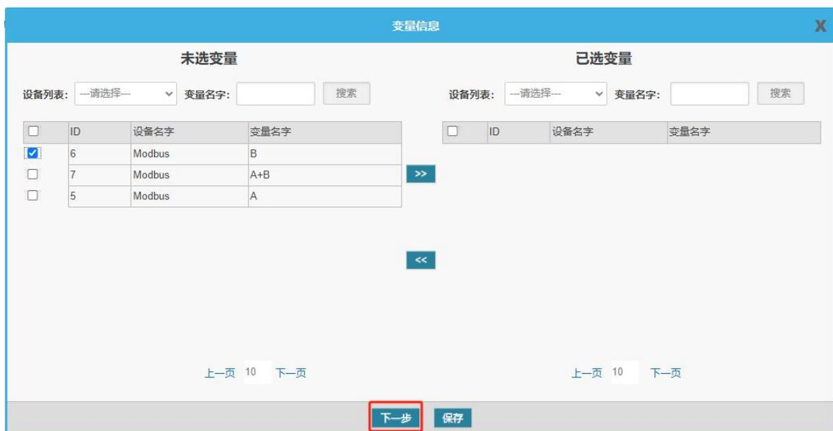
在此页面可以配置 IEC104 协议的地址映射表，可自定义上报地址、下控地址，配置好地址映射表后点击保存。
