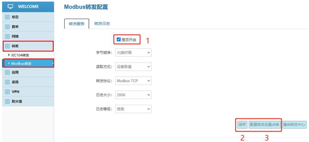
配置转发变量点表,从“未选变量”列表中选择对应要转发的设备变量，转到“已选变量”中，点击下一页。
