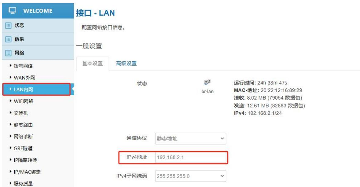
(3) 通过 LAN 口配置上网，基本设置里，IPv4 地址填写上一级路由分配过来的静态 IP。（注意：开启 LAN 上网，需将拨号网络与 WiFi 功能关闭掉）
