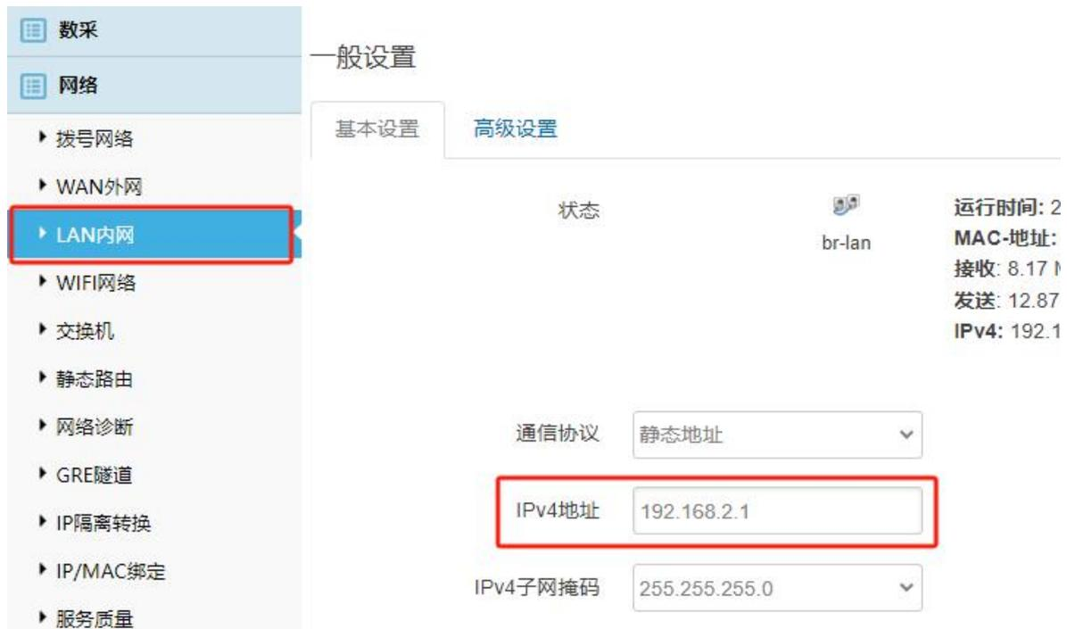
① 通过 Delta 编程软件，获取 Delta 控制器网口参数。
