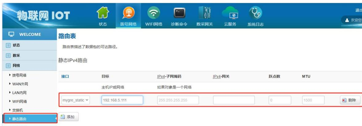
电脑上增加路由（网关底下所挂的设备不同网段即可跳过此步）
