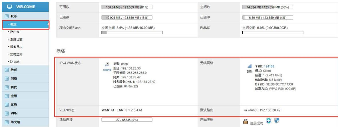
如上图状态中的 IPV4 WAN 状态中看到已经获取到上级路由分配的 IP 地址就证明网关连上 WiFi，可以正常上网了，严谨起见，再通过诊断命令 ping 下百度，确认下是否能正常上网。（同上面的诊断界面）
