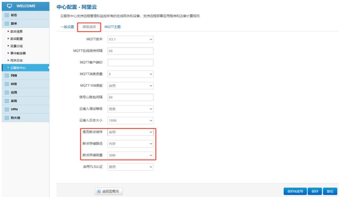
注：断点存储容量大小，请根据网关型号以及插入的 TF 卡容量大小选择合适的内存。
