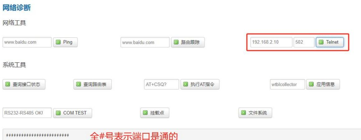
执行 AT 指令：“AT+CSQ?” 可查询物联网卡的信号；如下图所示，[+CSQ: 28,99]，28 为信号值最大信号值为 31 显示 99 则为无信号；99 为误码率。
