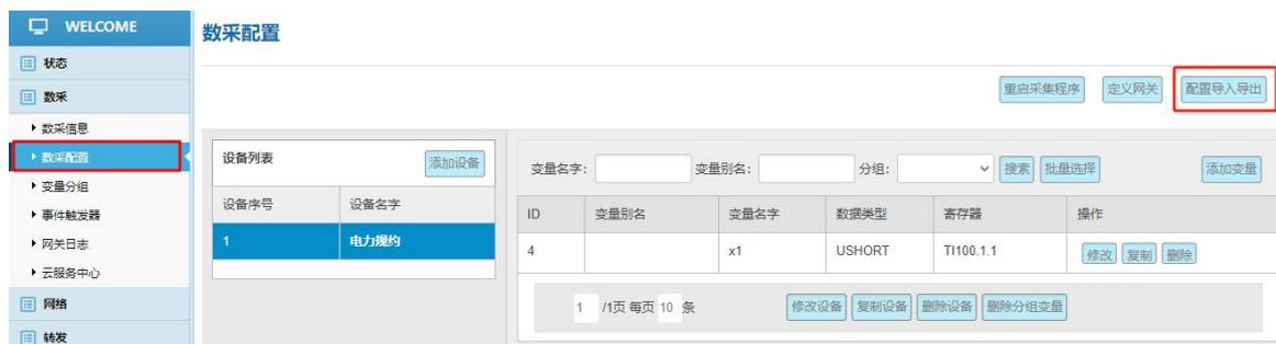
分别导出设备配置和变量配置，然后将其导入到其他网关的设备配置和变量配置中。
